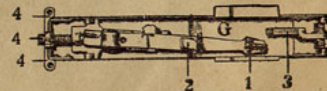
T, transportador.—1, diente.—2, talón.—3, trinquete.—4, pestillo.—G, tapa superior del cajón.
